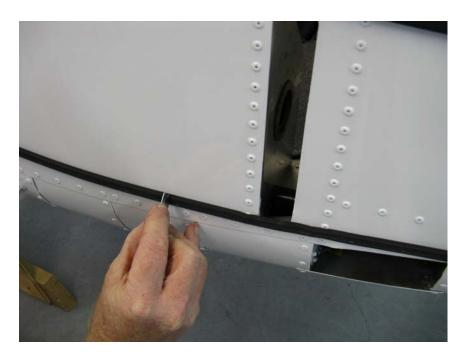
FIGURE 3: CUTTING SEAL STRIP
